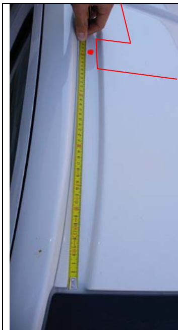
4: Encaje a la altura del agujero en el punto de soldadura de la canal de agua. Solo de la chapa fina del coche para que el marco de hierro pueda bajar lo máximo
